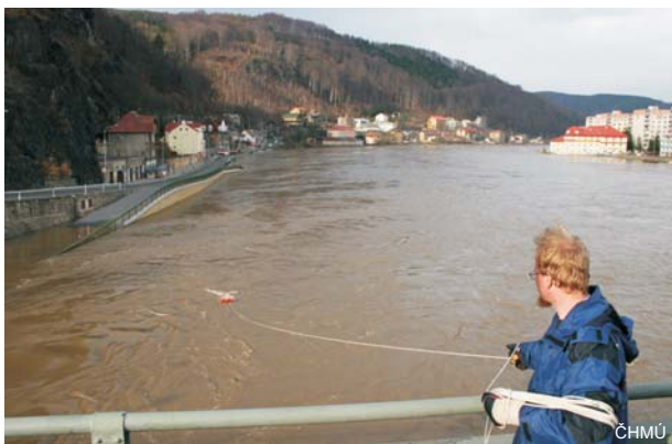
Obr. 4.2-2: Měření průtokoměrem ADCP na Labi v Děčíně – povodeň 2006
