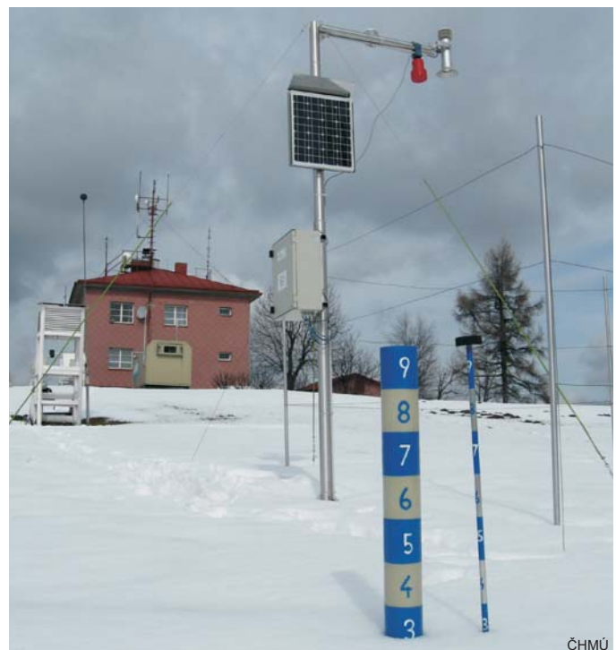
Obr. 4.2-1: Automatická sněhoměrná stanice Svatouch
