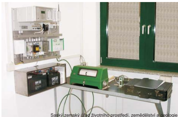
Obr. 4.2-3: Záložní vybavení vodoměrné stanice Aue3 na toku Zwickauer Mulde
